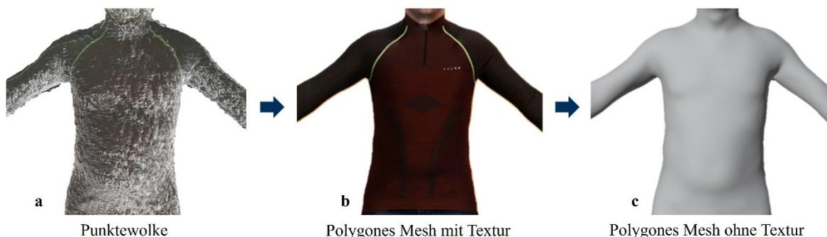
Abb. 2 Datenaufbereitung nach dem 3D-Body-Scan: a) von der initialen Erfassung des Anwenders als Punktwolke über b) die automatische Generierung eines homologen Meshs (Polygons) bis zur c) finalen Darstellung des untexturierten Modells.
