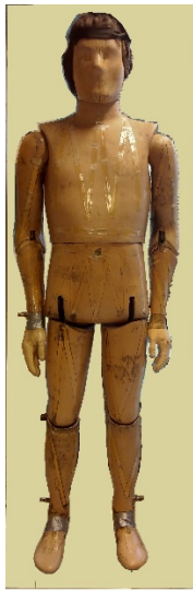
Fig. 4 (a) Tore – sweating thermal manikin
